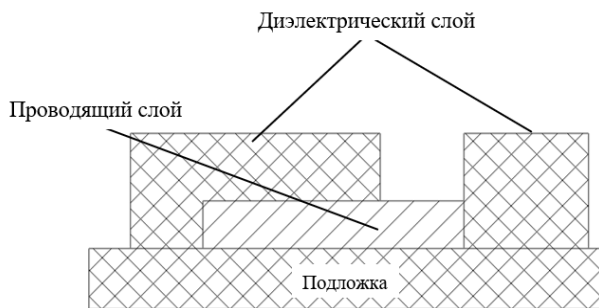
Рис. 2. Поперечное сечение топологии
