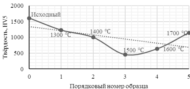
Рис. 3. Зависимость твёрдости по Виккерсу от температуры
