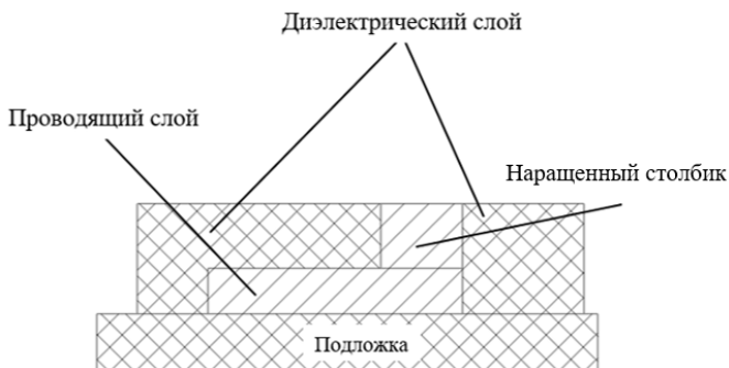
Рис. 4. Поперечное сечение топологии с наращиванием столбика
