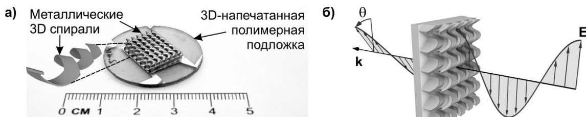
Рис. 1. а) Фотография двухслойной решетки ленточных металлических левовинтовых спиралей на полимерной подложке. Диаметр и шаг спиралей соответственно 1,1 мм и 2,2 мм, расстояние между слоями спиралей 1,1 мм и толщина пленки Ag-серебра 0,5 мкм. б) Схематичное изображение вращения плоскости поляризации электромагнитного излучения на угол \theta киральным метаматериалом на основе металлических спиралей.
