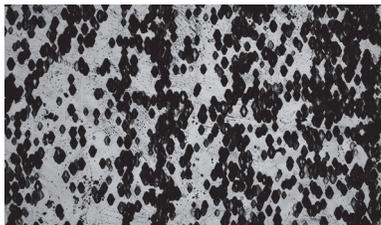
Рис. 1. Дислокационные ямки травления на плоскости {100} пластины GaAs
