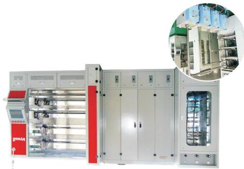
Рис. 1. Внешний вид горизонтальной установки LPCVD SUNRED
