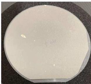
Рис. 5. Пластина:  $\varnothing 150$  мм; LT и стекло; бондинг: ALoT. Толщина LT до утонения: 350 мкм [1]
