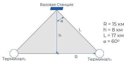
Рис. 1. Схема организуемого канала связи
