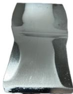
Рис. 3. Развитие канальной неоднородности при изменении температурных и динамических условий выращивания монокристалла InSb в направлении [111]
