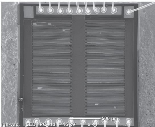
Рис. 3. Кристалл p-GaN HEMT в металлокерамическом корпусе МК КТ-95С-1
