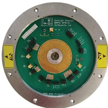
**Рис. 1.** Внешний вид проб-карты. Контроль параметров проб-карты осуществлялся с использованием платы-заменителя кристалла
