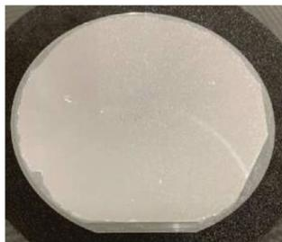
Рис. 7. Пластина ЛТ после утонения до толщины 5 мкм [1]
