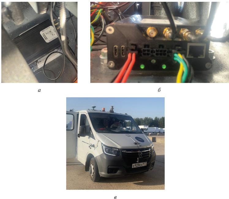
**Рис. 9.** Размещение ИКНС: а) Установка ИКНС, б) подключение оборудования, в) установка антенн
