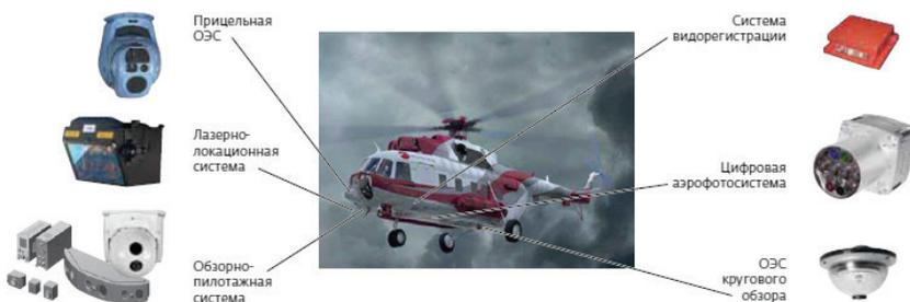
Рис. 1. 16 — Бортовые оптико-электронные системы вертолетов
