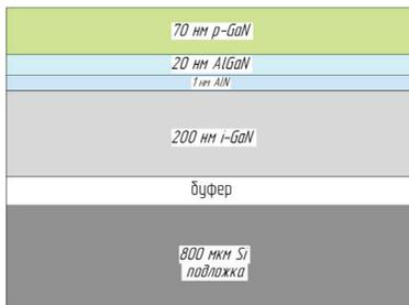
Рис. 1. Конструкция p-GaN/Al<sub>0,25</sub>Ga<sub>0,75</sub>N/GaN/Si-гетероструктуры
