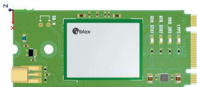
Рис. 3. Топология ГНСС приемника ZED F9P
