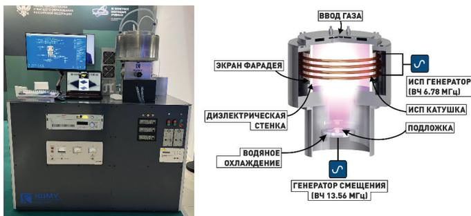
Рис. 1. Внешний вид созданной установки ПХТ и 3D-модель реактора установки ПХТ
