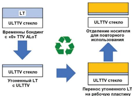
Рис. 4. Утонение LT со стеклянным носителем со сверхнизким TTV и бондингом ALoT [1]
