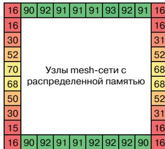
Рис. 1. Интенсивность отправки при заданной равномерной интенсивности 100% в mesh 10x10 с алгоритмом DOR
