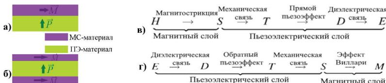
Рис. 1. Схематическое изображение (а) двухслойного и (б) трехслойного МЭ-композитов и принцип появления в них (в) прямого и (з) обратного МЭ-эффекта
