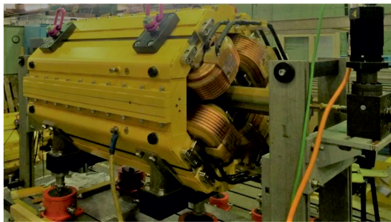
Рис. 7. Измерение квадруполь Q2 вращающейся катушкой Fig. 7. Measurement of quadrupole Q2 by rotating coil
