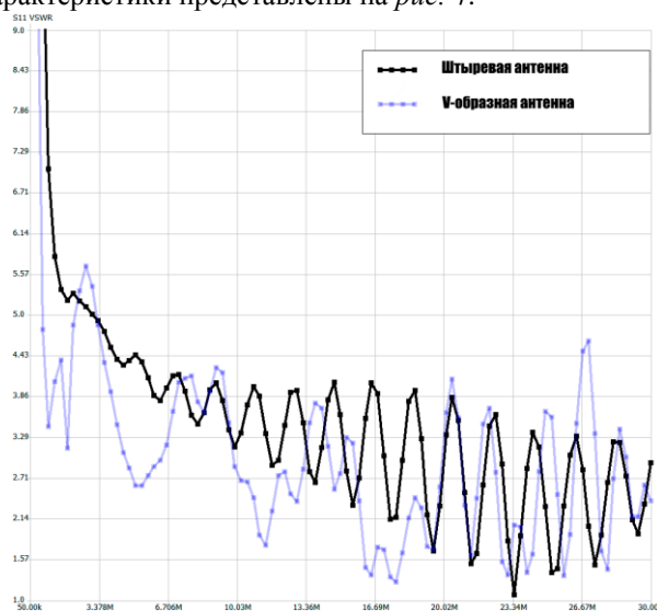
рис.4. КСВ измеренное NanoVNA v2.
