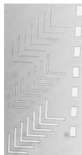
Рис. 3 Травление SI-GaAs по маске ПММА с предобработкой
