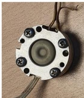
Рис. 3 Собранный электрохимический сейсмометр с данным элементом
