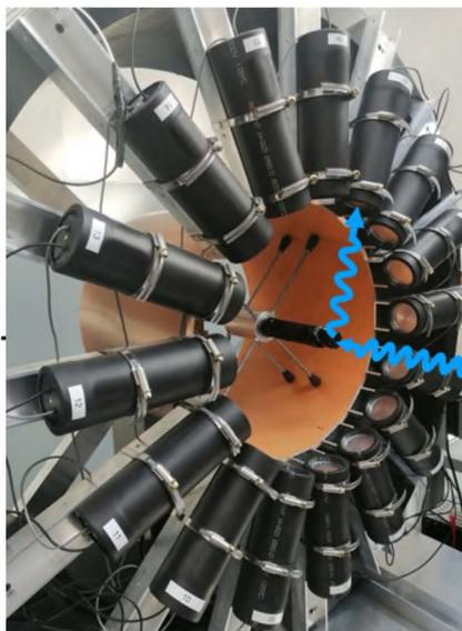
Рис. 1. Фотография плеча установки для изучения комптоновского рассеяния аннигиляционных фотонов в ИЯИ РАН. В центре плеча на оси установки установлены два, промежуточный и основной, рассеивателя из скintилляторов. Вокруг основного рассеивателя установлены 16 счетчиков рассеянных фотонов, образуя 16 комптоновских поляриметров. Синей линией обозначен путь фотона из источника
