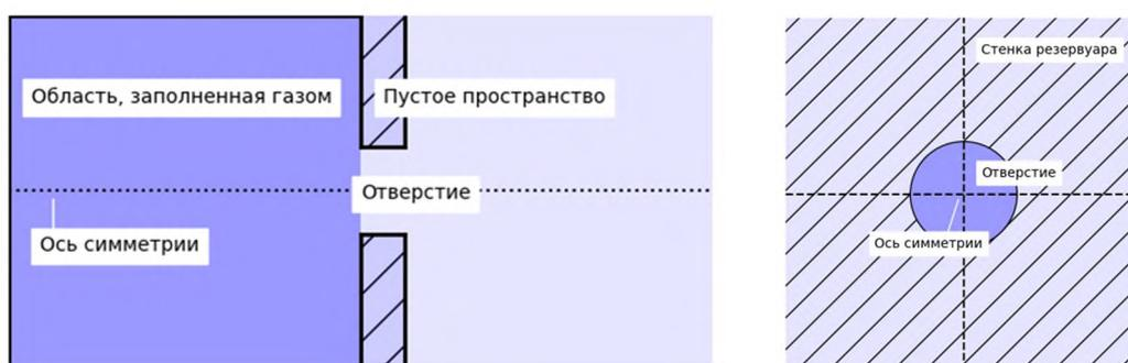
Рис. 1. Схема установки в модельной задаче
