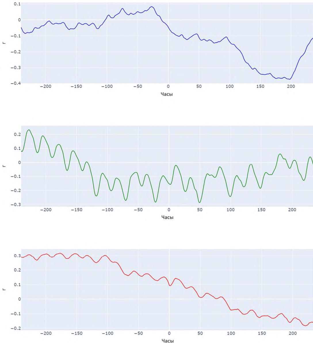
Рис.1. Распределение коэффициентов корреляции Пирсона ( $r$ ) для пар радоновые данные-давление (синяя линия), радоновые данные-влажность (зеленая линия), радоновые данные-температура (красная линия) в зависимости от сдвига по времени для первого периода измерений с 1 июня 2019 года по 25 июля 2019 года.
