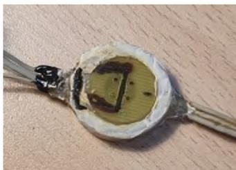
Рис. 2 Образец электрохимического элемента с устройством локального подогрева
