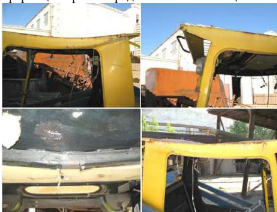
Рис. 3 – Деформация кабины после падения груза
