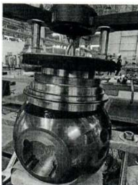
Рис. 3 – Процесс притирки седла к пробке шаровой DN150
