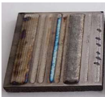
Рис.3 – Фотография многослойного образца, наплавленного методом прямого лазерного выращивания.
