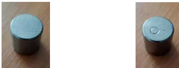
Рис. 2 – Характерный внешний вид образца (ролика) перед испытаниями (слева) и после испытаний (справа)
