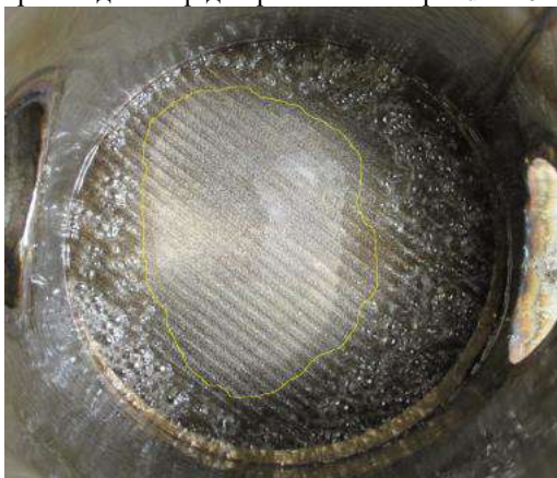
Рис.1 – Фрагмент видеосъемки кипящего слоя HFE-7100 с появлением сухой поверхности
