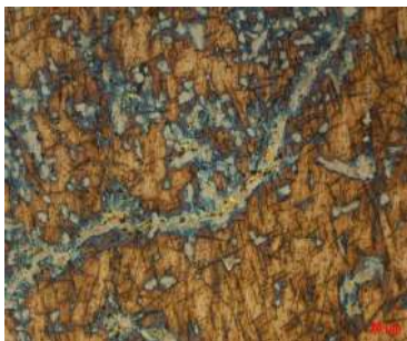
Рис. 2 – Структура образца после отжига при 500 °С.
