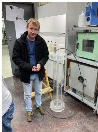
Рис.2. Форма полимеризации экспериментального образца вакуумного транспортного канала для новых ускорителей, разрабатываемых в ИЯФ СО РАН
