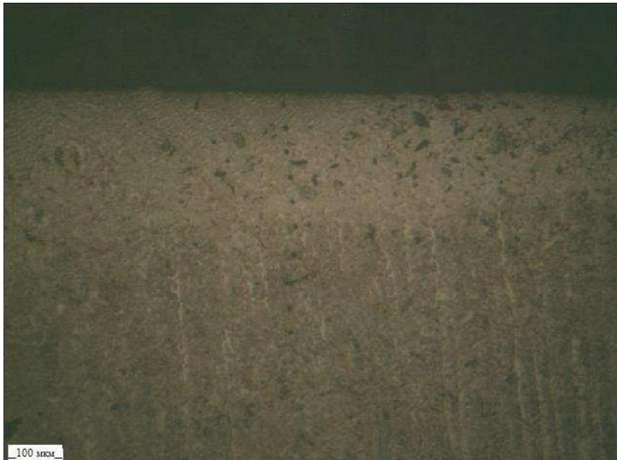
Рис.1. Слой на основе  $\text{CrB}_2$  на стали Х12МФ.
