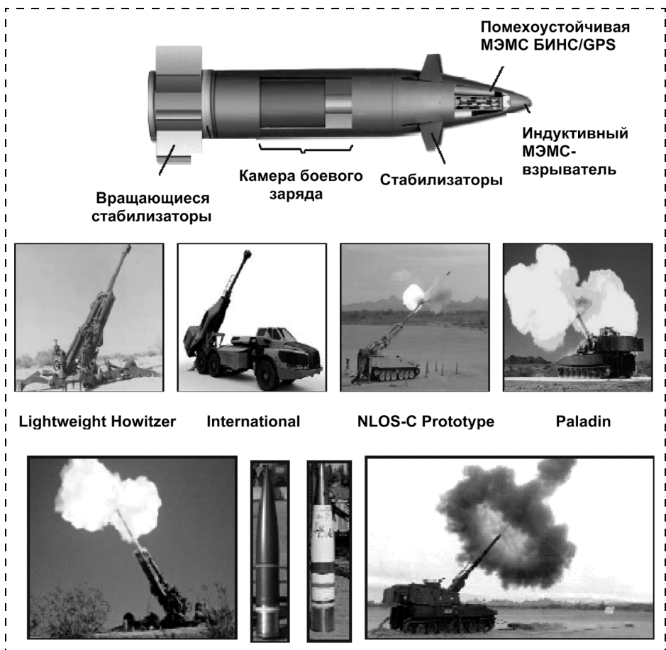
Рис. 1. "Умные" МЭМС-оснащенные снаряды типа XM982 ( Excalibur ) для стрельбы из 155-миллиметровых гаубиц и самоходных орудий с автоматизированными системами управления стрельбой
