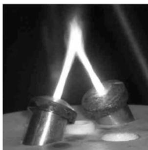
Рис. 1. Двухструйный плазмотрон переменного тока килогерцового диапазона
