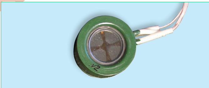
Рис.5 Вакуумный ИЧФ с четырьмя фоточувствительными площадками
