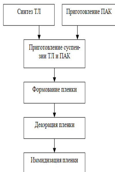
Рис.1. Технологическая схема получения термолуминесцентной пленки на основе ПАК
