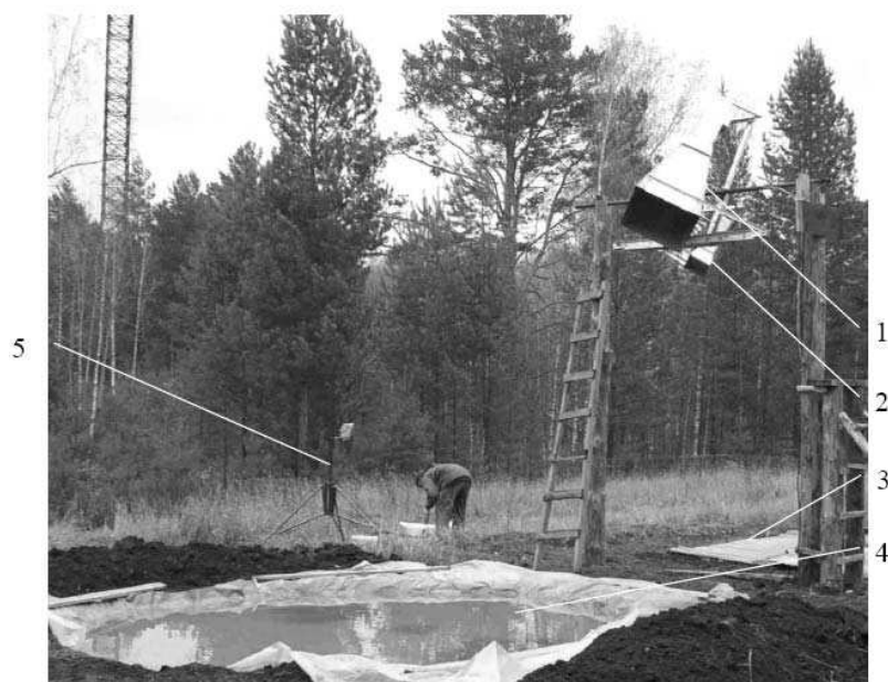
Рис. 1. Вид радиометрического комплекса при калибровке радиометров. 1 – радиометр 1,4 ГГц, 2 – радиометр 6,9 ГГц, 3 – металлический лист, 4 – бассейн с водой, 5 – метеостанция
