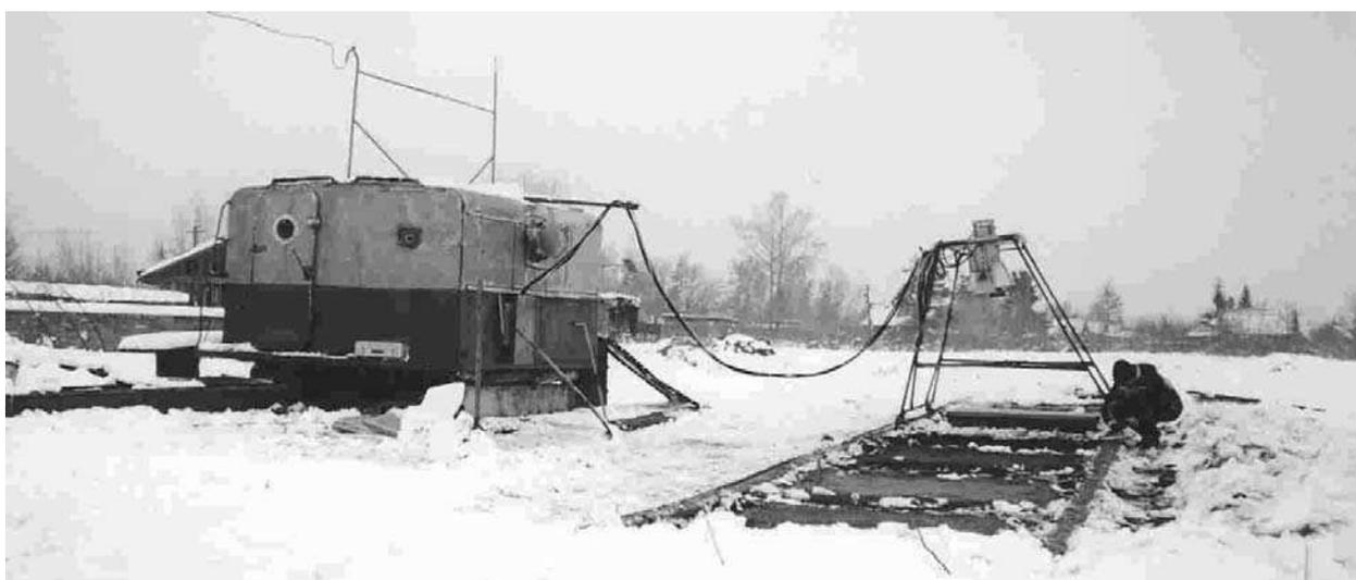
Рис. 4. Радиометрический комплекс на частоты 2,7, 6 и 8,2 ГГц
