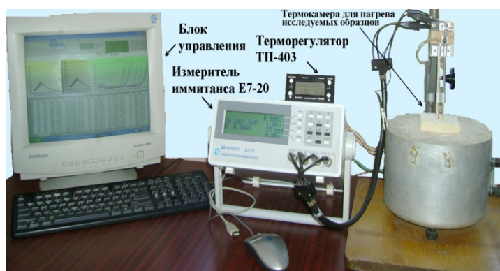
Рис. 1. Автоматический измерительный стенд на базе "Измеритель иммитанса Е-7-20"
