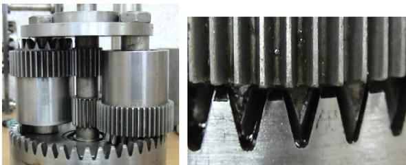
Рис. 2. Планетарный редуктор, сочетающий торцевые и эвольвентные зубья на сателлитах
