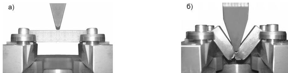
рис 1. Схема эксперимента на трехточечный изгиб на испытательной машине INSTRON VHS – 40/50:
