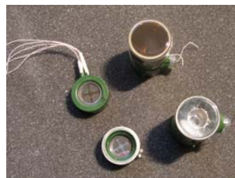
Рис. 5. Фотография различных исполнений фотоприемника
