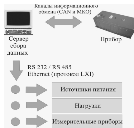
Рис. 2. Взаимодействие системы «Лотос» с аппаратной частью
