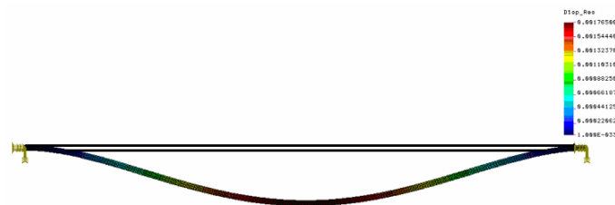
Рис. 3. Распределение прогибов при классическом заземлении торцов
