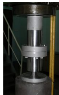
Рис. 1. Модель инструмента и заготовки для интенсивной пластической деформации:
