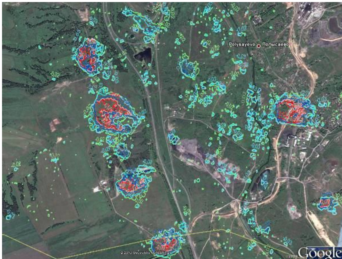
Рис.3. Квик-лук веб-портала Google с нанесенными изолиниями просадок грунта для пары 17 июня - 2 августа 2010г.
