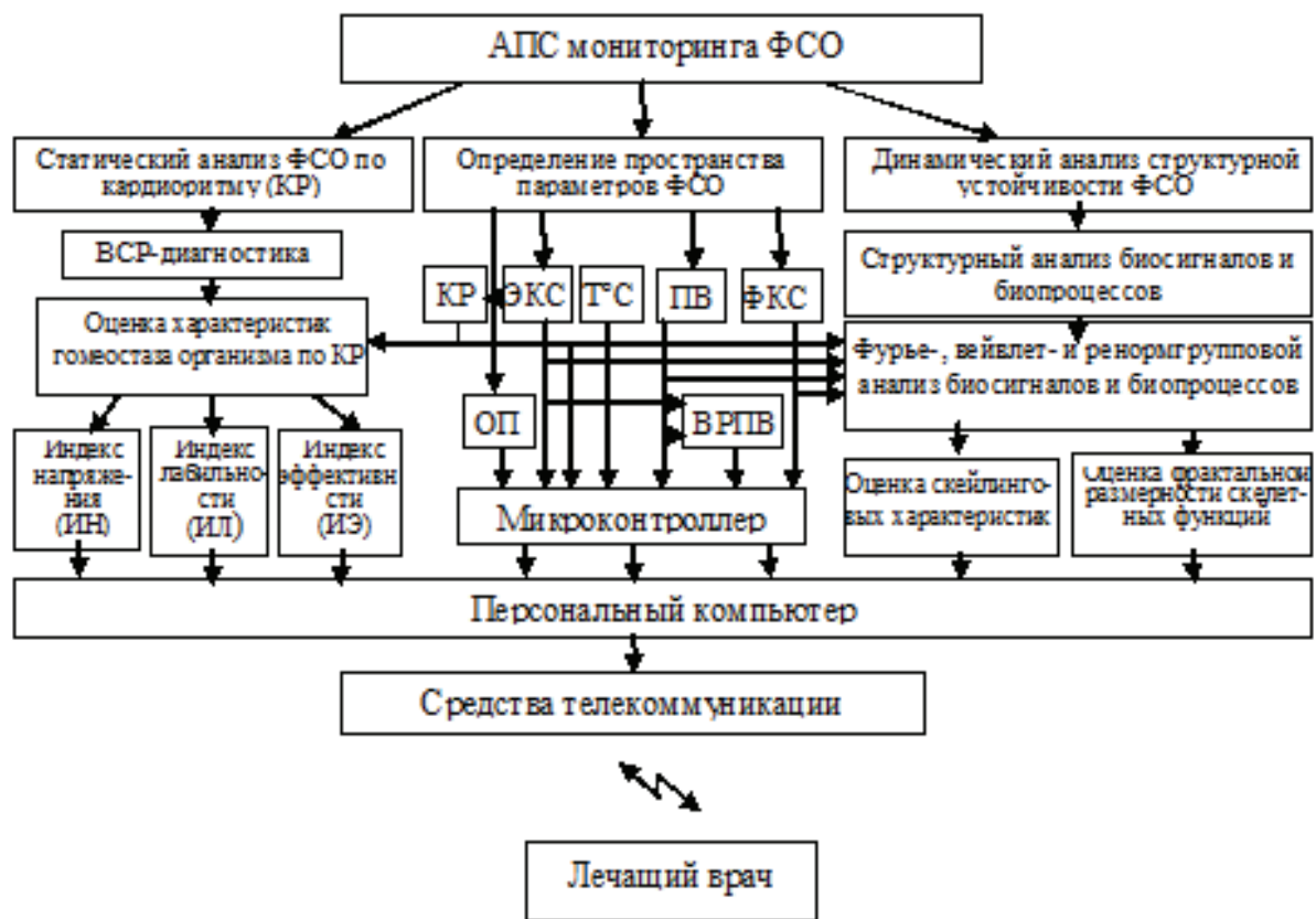
Рис. 1. Структура мобильного полифункционального АПК мониторинга ФСО
