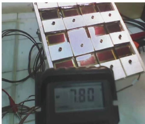
Рис. 2. Модуль с 13 солнечными ячейками под облучением 50-ваттной люминесцентной лампы ( U_{oc} = 7,8 \text{ В} )
