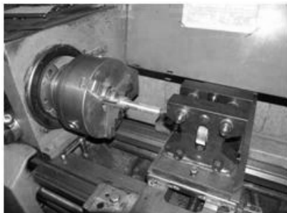
Рис. 2. Станочное приспособление для накатывания мелкозубчатых колес
