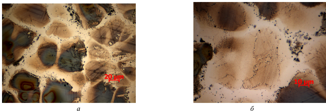
Рис. 5. Микроструктура сплава ZK60A после двухступенчатой гомогенизации: a – \times 500 ; б – \times 1000
