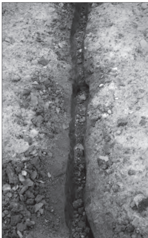
Рис. 5. Участок расчищенной грунтовой прорези с видимыми зонами сжатия и развала мерзлого грунта.
