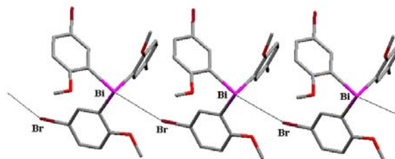
Рис. 2. Строение полимерной цепи в кристалле I.
