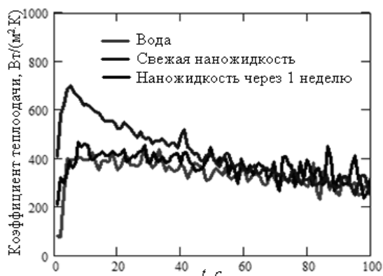
Рисунок 3 – Зависимость от времени коэффициента теплоотдачи в процессе охлаждения цилиндра
