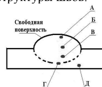
Рисунок 1 – Схема исследования микроструктуры сварного шва после травления
