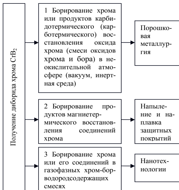
Рисунок 1 – Классификация способов получения диборида хрома \text{CrB}_2
