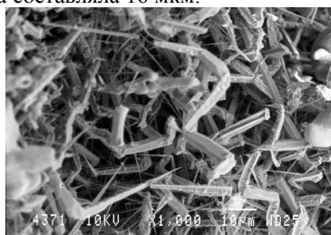
Рисунок 4 - Микрофотография продуктов сгорания нанопорошка алюминия в алундовом тигле при воздействии неоднородного магнитного поля
