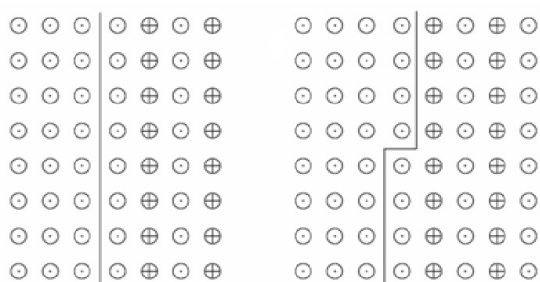
Рисунок 10 - Схема границы раздела ферро- и антиферромагнитных структур. Здесь каждый атом имеет вектор магнитного момента направленный либо за чертёж, либо из чертежа [4].
