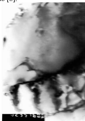
Рисунок 3 - Тонкая структура кремневой пластины в сплаве АК-12 после СГП, \times 60000 .
