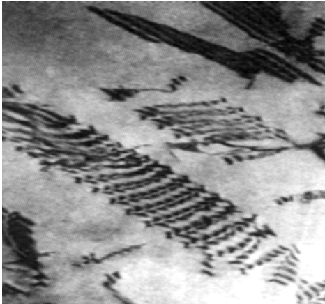
Рисунок 7 - Электронные микрофотографии дислокационной структуры закаленной аустенитной стали. Показано зарождение линзовидных кристаллов в местах скопления дислокаций \times 55000
