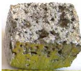
Рис. 1. Образец (40×35×35 мм) из пеноалюминия марки А7
