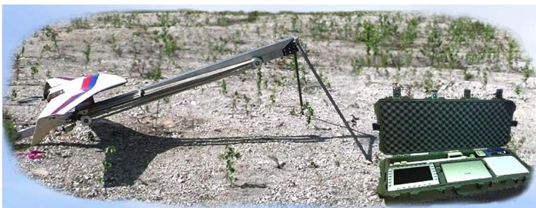
Рис. 3. Беспилотный летательный аппарат «DELTA»
