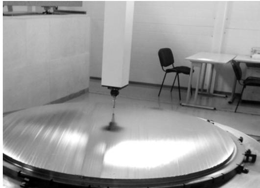
Рис. 3. Процесс обмера поверхности оправки
