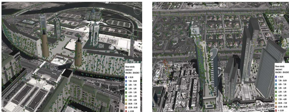
Рис. 3. Постоянные рассеиватели радарного сигнала, выявленные по методу PS, увеличение на застроенную территорию Астаны
