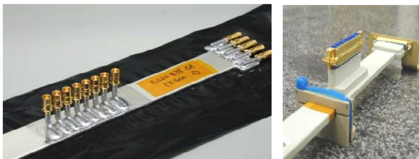
Рис. 2. а – вывод проводов со слоев шины; б – Вывод цепей с шины соединителем
