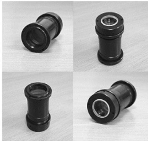
Рис. 3. Экспериментальный образец оптической системы звездного датчика
