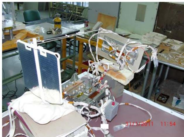
Рис. 2. Контурная тепловая труба совместно с газорегулируемой тепловой трубой на приборном кронштейне перед установкой на МКА «МиР»
