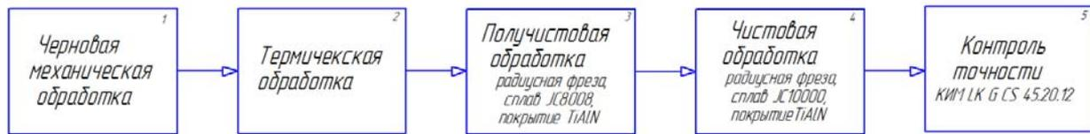
Рис. 2. Последовательность этапов обработки оправки
