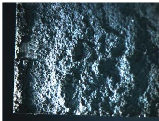
Рис. 2. Фотографии излома металлокерамики УМБ-4с ( $\times 0,65$ )
