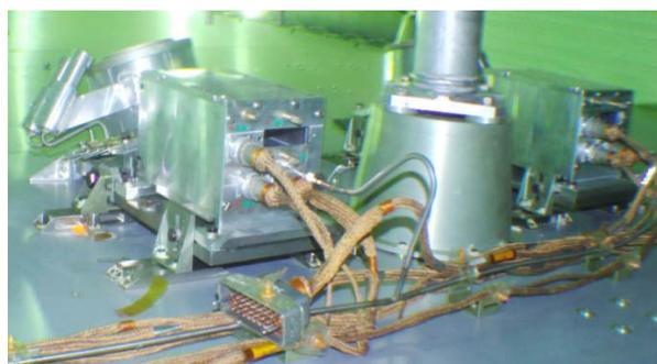
Рис. 2. Способ выставки блока коррекции вращением и перемещением
