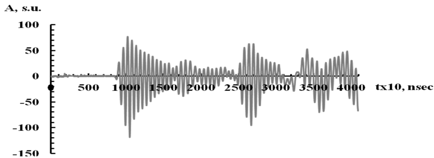
Fig. 2. Oscilloscopegramma of impulses with longitudinal polarization in TiO_2 .
