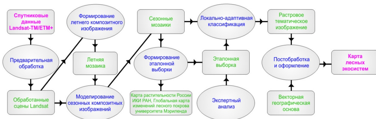
Рис. 1. Общая технологическая схема картографирования лесных экосистем по спутниковым данным Landsat
