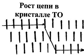
Рис.8. Изменение направления роста цепи ПОМ в кристалле ТО из-за отсутствия полной когерентности решеток мономера и полимера. Вертикальные линии - циклические молекулы ТО, (-CH_2-O-)_3 .
