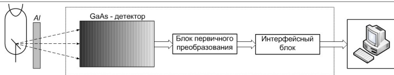
Рис. 1. Структурная схема рентгеновского спектрометра.
