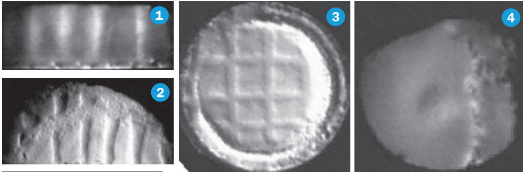
Рис. 1. Оптическое изображение, сформированное нанесенной проводящей маской с последующей термообработкой. \text{LiNbO}_3 , Z-срез
