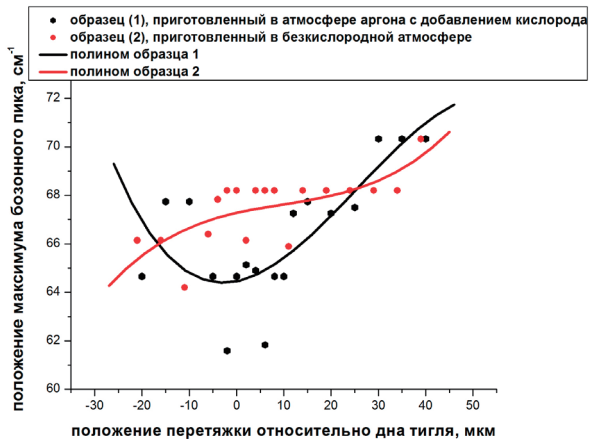
Рис. 1. Положение максимума бозонного пика как функция положения перетяжки относительно дна тигля для образцов стекла тетрабората стронция, приготовленных в бескислородной атмосфере и в атмосфере, обогащенной кислородом. Точки – экспериментальные данные, линии – аппроксимация полиномом третьего порядка
