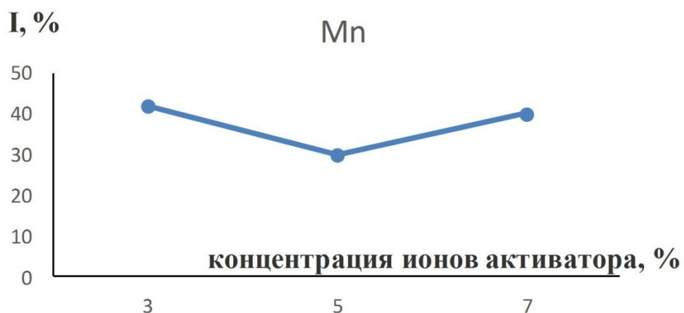
Рис. 4. Зависимости интенсивности от концентрации активаторов с временем воздействия облучением 1 час.
