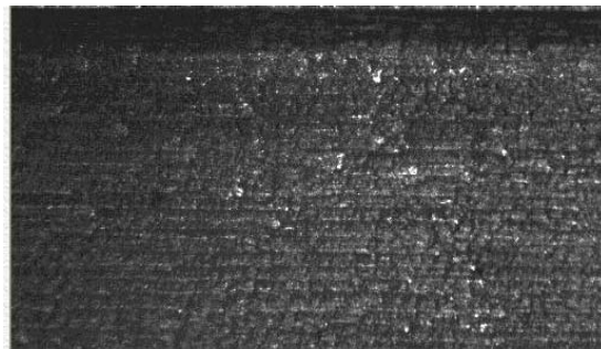
Рис. 2. Шероховатость поверхности при обработке пластиной CNMG 120404-EM
