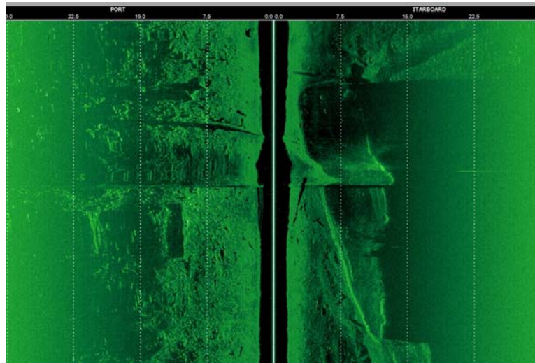
Рис. 3. Пример гидроакустического снимка с резким волнообразным искажением донного объекта (затонувшего судна). Причина – резкий подъем буксируемого модуля с целью предотвращения его зацепления за донный объект
