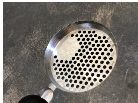
Рис. 2. Готовые отверстия диаметром Ø1,29Н7 в пресс-форме
