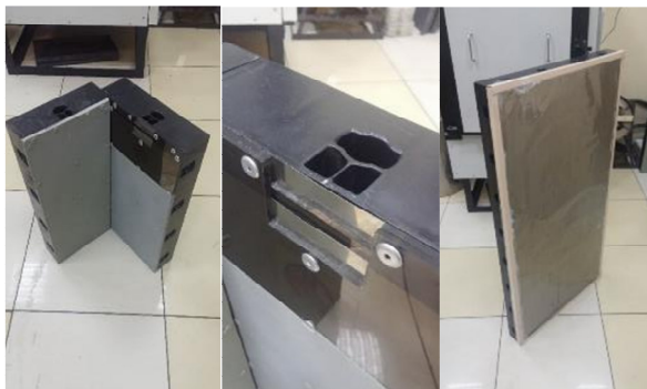
Рисунок 3 – Конструкции на основе модульных магнитных экранов.
