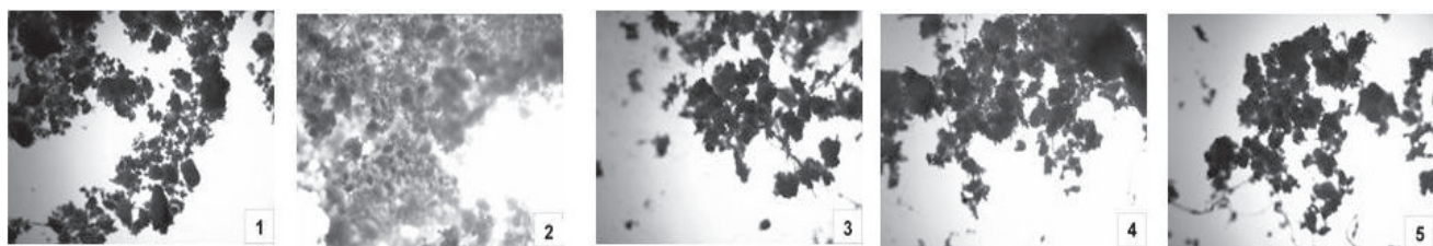
Рис. 3. Морфология осадков с добавлением аминокислот: 1 – без добавок; 2 – Glu; 3 – Gly; 4 – Ser; 5 – Asp
