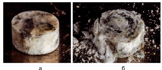
Рис. 1. Разрушение образца при одноосном сжатии: (а) исходное состояние; (б) после сжатия
