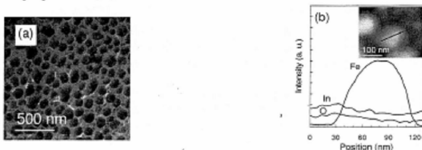
Рис.7 Электронно-микроскопическое изображение Fe наночастиц со средним размером 100 нм, вложенных в \text{In}_2\text{O}_3 матрицу (а); (b) Электронно-микроскопическое изображение и EDS профили концентраций Fe, In, и O по линии через частицы в нанокompозите Fe- \text{In}_2\text{O}_3 .
