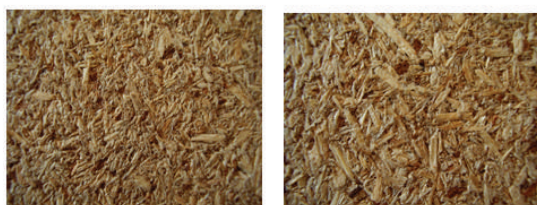
Различие структуры поверхности плит после обработки термосиловым воздействием и методом шлифования
