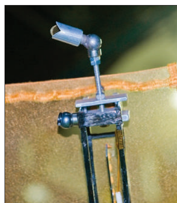
Рис. 2. Крепление цилиндрической метки (способы установки)
