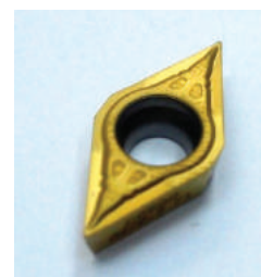
Рис. 2. Сменная многогранная пластина SECO™ CP500 DCMT11T302-F1
