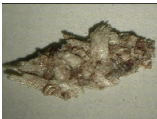
Микрофотографии осмоленной древесной частицы (стружки) с заглушенными порами полимеризованной смолой
