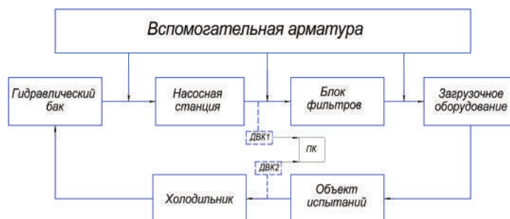
Обобщенная структурная схема типового стенда для испытаний гидравлических агрегатов с ДВК
