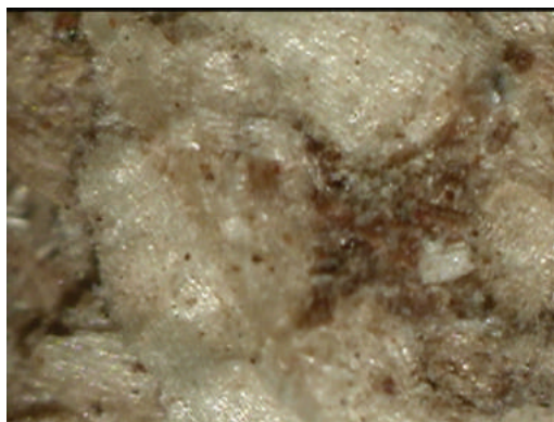
Микрофотографии осмоленной древесной частицы (стружки) с заглушенными порами полимеризованной смолой
