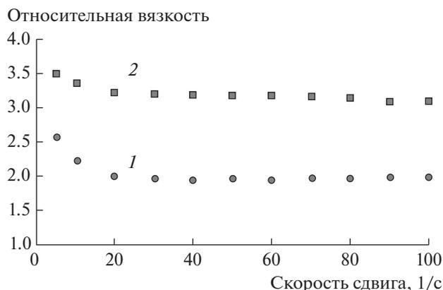
**Рис. 6.** Зависимости относительной вязкости от скорости сдвига: 1 – исходная дисперсия, 2 – дисперсия наночастиц алмаза с серебром.
