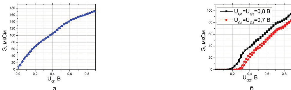
Рис. 2. Зависимость проводимости двухзатворной (а) и шестизатворной (б, в) структур от приложенного к затворам напряжения
