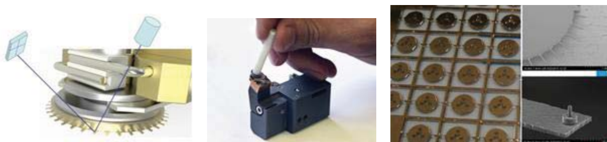
Рис. 2. Схема СЗМ с картриджами, установка картриджа на измерительную головку и образцы многозондового картриджа
