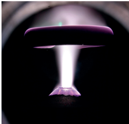
Рис. 2. Фотография ВЧ дугового разряда между холодными медными электродами, при пониженном давлении
