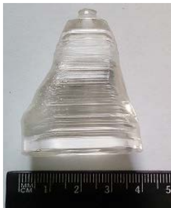
Рис. 2. Кристалл LZM, выращенный с использованием дополнительно очищенного \text{MoO}_3 .
