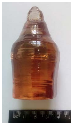
Рис. 1. Кристалл LZM, выращенный с использованием стандартных реактивов.
