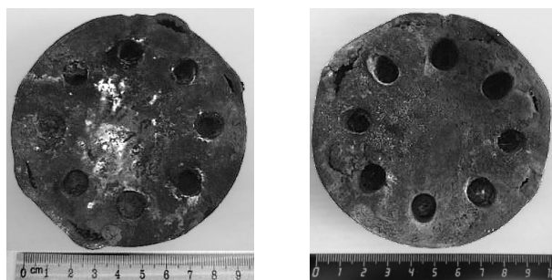
Рис. 2. Внешний вид матриц после ударно-волнового нагружения исходных (слева) и механоактивированных составов (справа).
