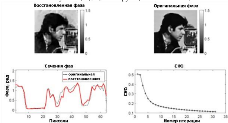
Рис. 2. Результат восстановления объекта: верхний ряд – восстановленная фаза (слева) и оригинальная фаза (справа); нижний ряд – продольные сечения фаз (слева) и график зависимости средней квадратичной ошибки в зависимости от номера итерации (справа)
