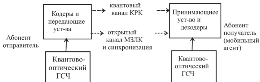
Рис. 1. Принцип построения совмещенной схемы каналов квантового распределения ключа и многозначно-логического кодирования для связи с мобильным агентом
