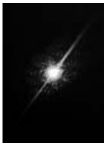
Рис. 1. Блики на удаленном экране при отражении лазерного излучения от плоской поверхности оптического элемента из монокристалла парателлурита
