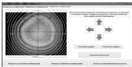
Рис. 2. Процесс компьютерного совмещения идеальной и реальной коноскопической картины монокристалла парателлуриата с целью расчета вариаций показателей преломления и механических напряжений в областях с оптическими аномалиями
