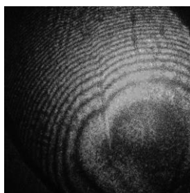
Рис. 1. Коноскопическая картина монокристалла ниобата лития со свилью в виде серии изломов на изохромах
