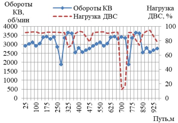
Рис. 2. Изменение нагрузки ДВС и оборотов КВ при движении в гору, селектор АКПП в положении D
