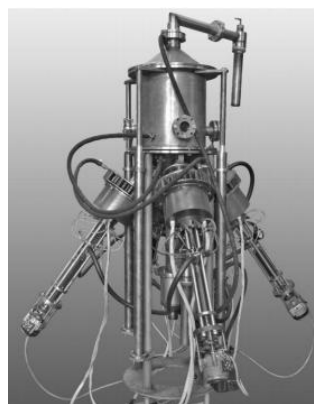
Рис. 4. Установка для синтеза фуллеренов при атмосферном давлении
