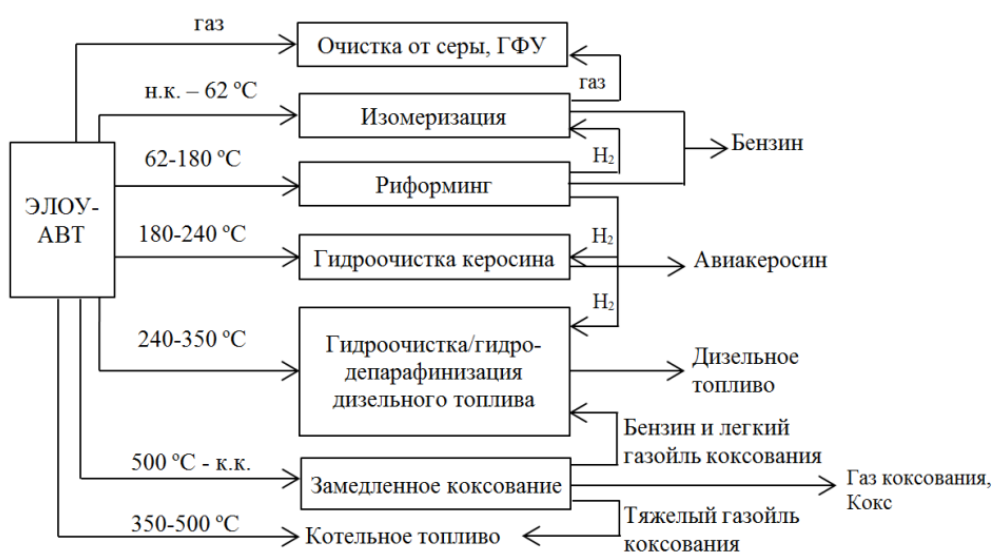
Рис. 2. Принципиальная схема сочетания УЗК и процесса гидроочистки прямогонных нефтяных фракций
