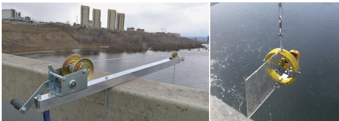
Рис. 1. Установка для построения вертикальных градиентов скоростей ветра
