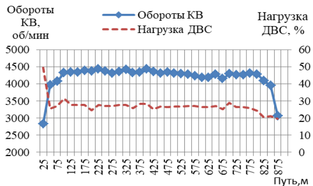
Рис. 6. Изменение нагрузки ДВС и оборотов КВ при движении в гору на первой передаче
