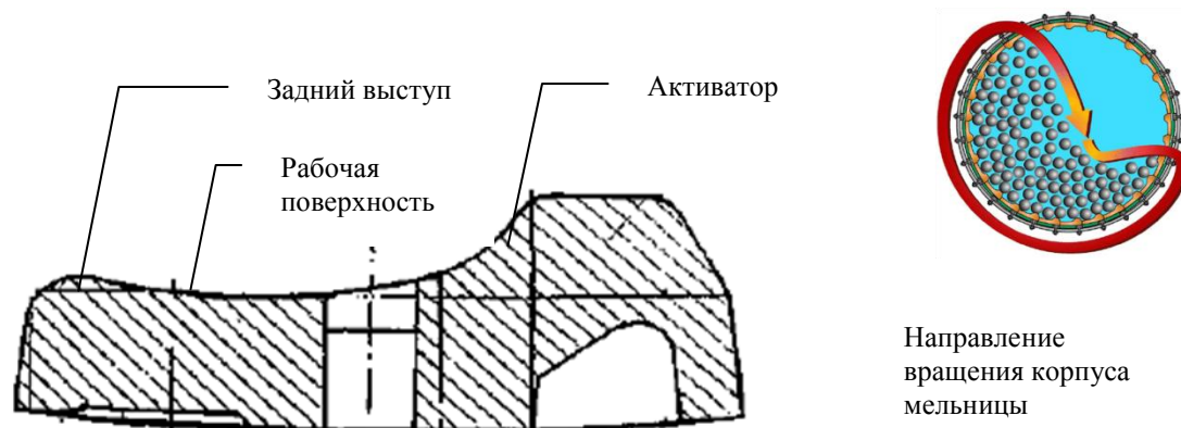
Рис. 4. Равномерно изнашивающийся профиль бронефутеровки
