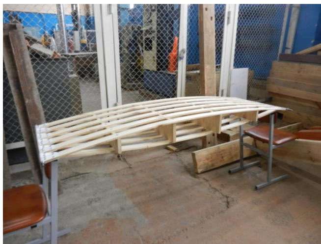
Рис. 8. ППП с раздвинутыми поясами и установленными стойками
