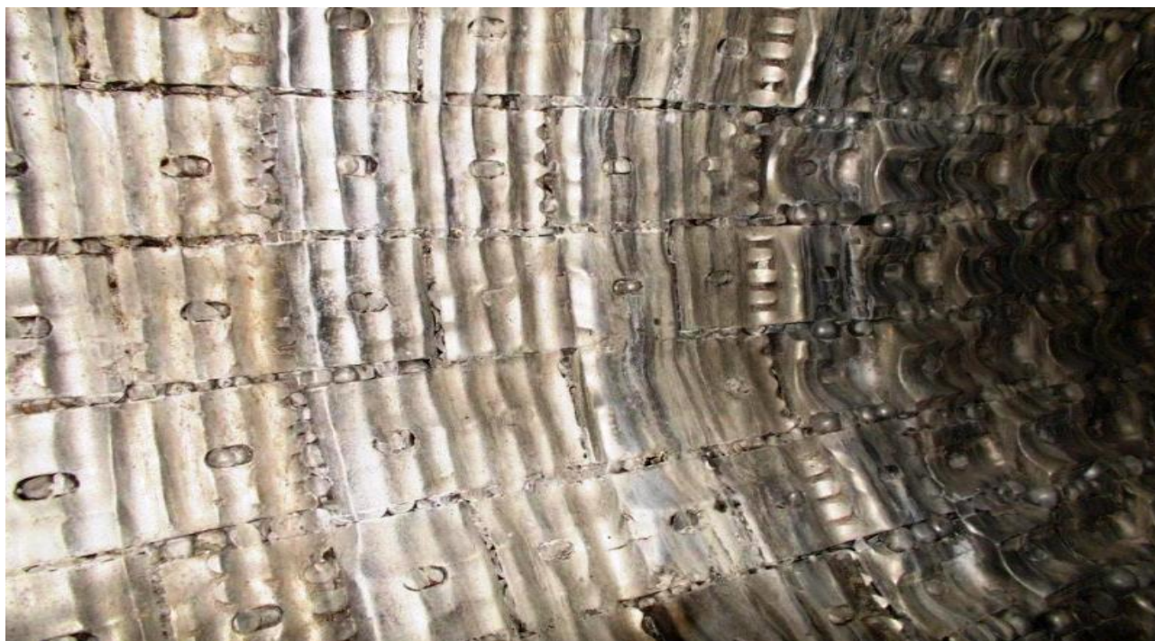
Рис. 2. Бронеплиты с изношенным профилем в процессе эксплуатации
