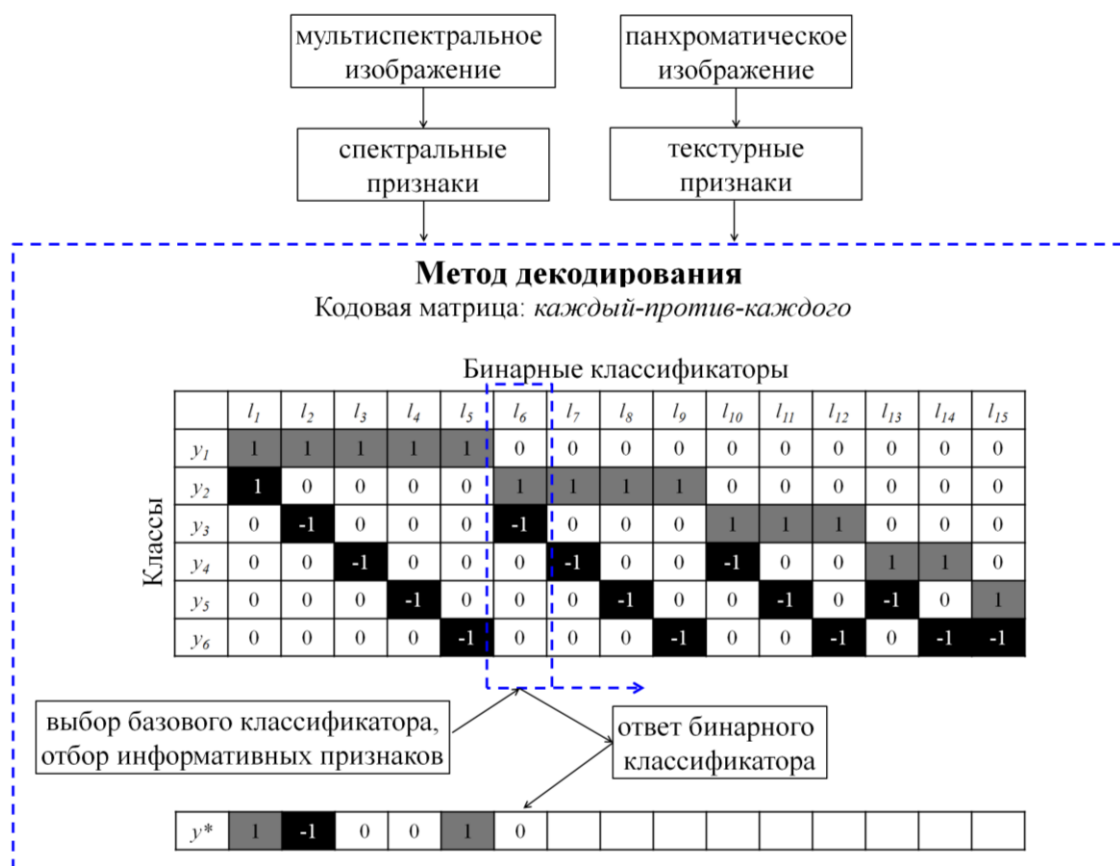
Рис. 1. Схема метода классификации наземных объектов на основе спектральных и текстурных признаков: y_i – наименования классов; l_i – метки бинарных классификаторов; y^* – метка классифицируемого объекта
