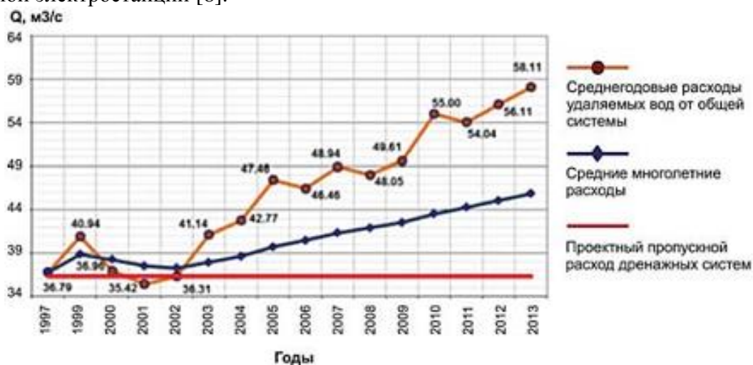
Рис. 3. Динамика изменения расходов сбрасываемых вод из коллекторно-дренажных систем Араратской равнины в период 1997–2013 гг. [7]
