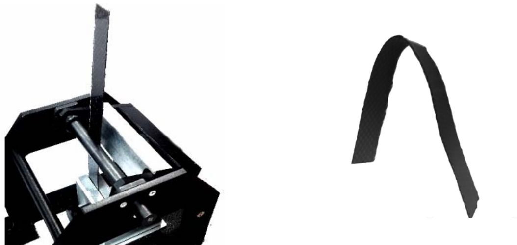
Испытания композита на изгиб с помощью прибора «КОНСТАНТА-ИЦ»
