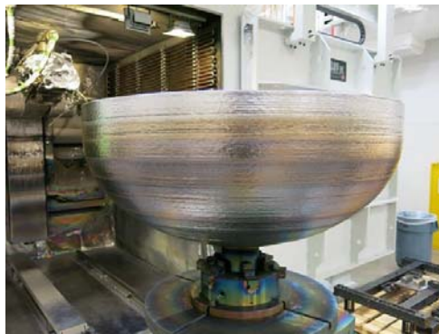
Рис. 3. Топливный бак, изготовленный методом аддитивного производства
