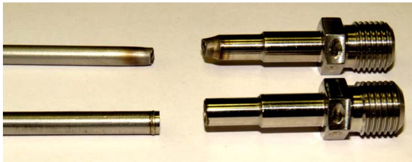
Рис. 2. Пример разрушения образцов при механических испытаниях на разрыв, сверху вниз: импульсная орбитальная автоматическая аргодуговая сварка, лазерная сварка
