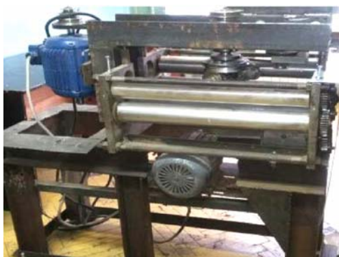
Рис. 1. Экспериментальный стенд для калибровки древесно-стружечных плит
