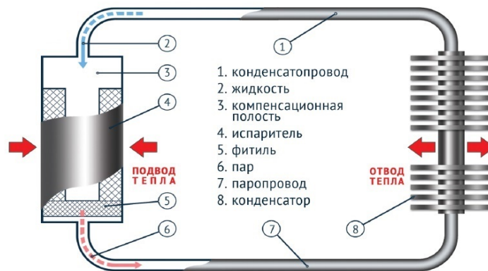
Рис. 3. Контурная тепловая труба
