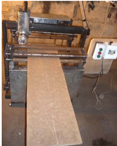
Рис. 3. Станок по обработки поверхности древесно-стружечных плит, имеющий кинематику поступательно-колебательного движения
