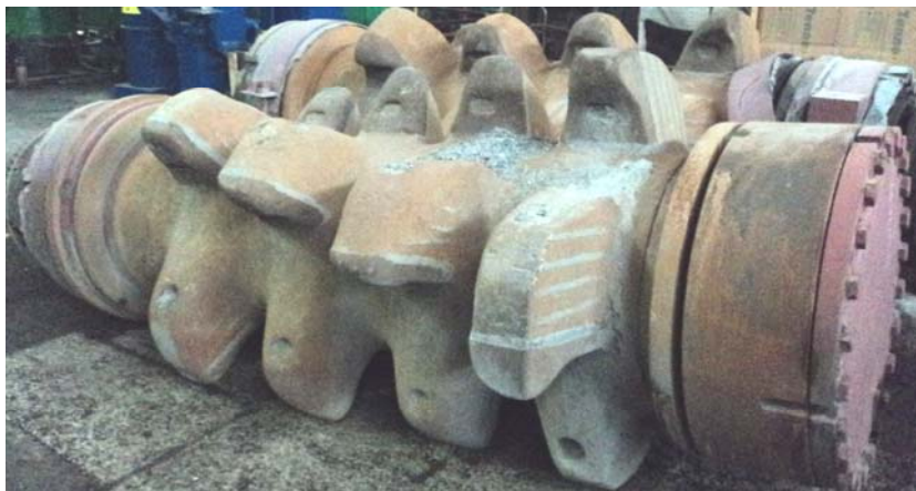
Рис. 3. Шнек зубчатый до ремонта (после эксплуатации)
