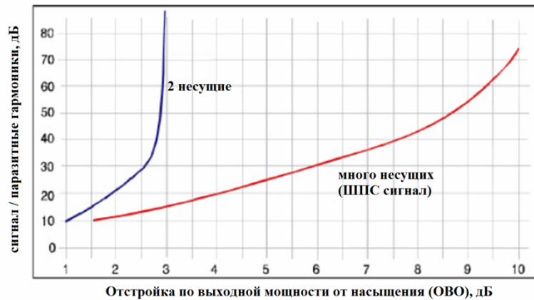
Рис. 2. Отношение сигнал/шум при воздействии двумя несущими
