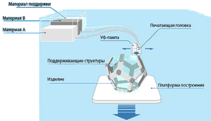
Рис. 2. Процесс нанесения материала и его сплавления
