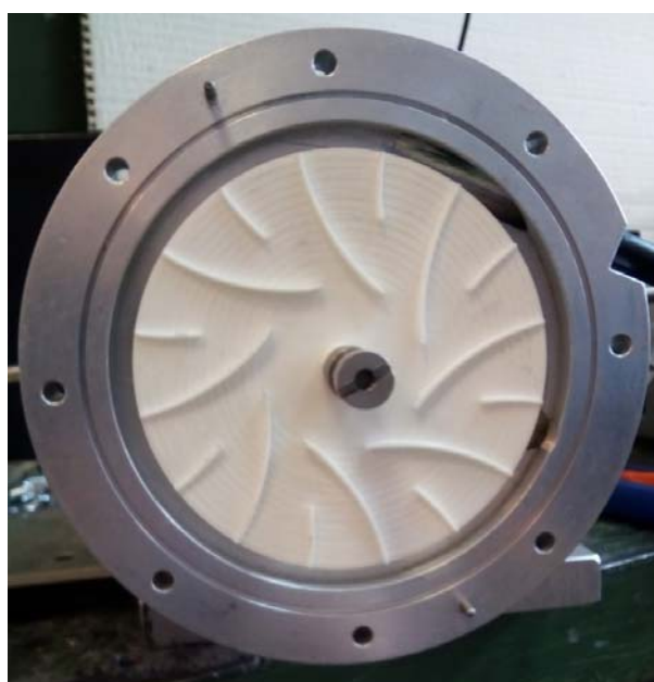
Рис. 2. Изготовленное методом 3D-печати колесо микротурбинной установки
