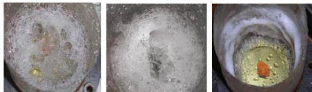
Рис. 1. Фотографии газо-жидкостной смеси на ступени при D = 114 мм: а – барботажный режим; б – кольцевой; в – пленочный
