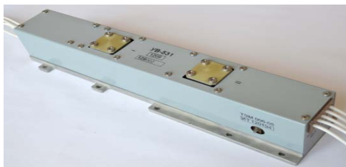
Рис. 1. Внешний вид ЛБВ 18–22 ГГц космического назначения
