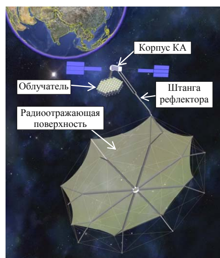
Типовая компоновка связного КА с КТА
