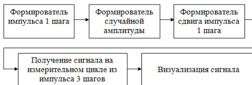
Рис. 1. Структура моделирующей программы
