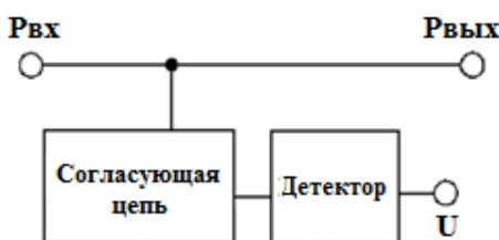
Рис. 4. Структурная схема детектора MD907
