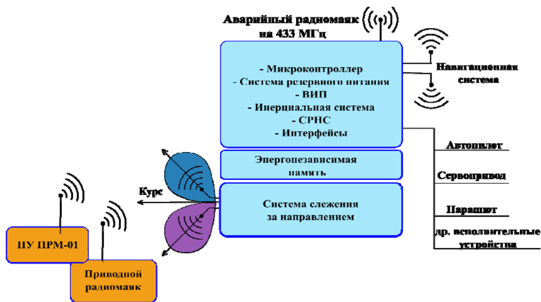
Рис. 1. Структурная схема САС БПЛА
