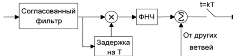
Рис. 2. Схема приемника ОФМ-2 сигналов при приеме на 2 антенны
