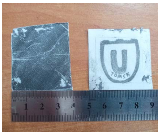
Рис. 2. Внешний вид непрозрачного экранирующего листа бумаги (слева), справа – исследуемый образец
