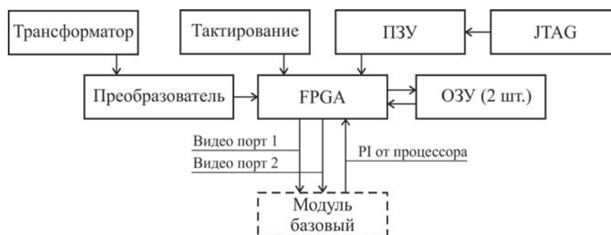
Рис. 2. Функционально-структурная схема модуля интерфейсного
