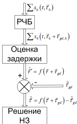
Рис. 2. Схема учета ГВЗ сигналов ГЛОНАСС
