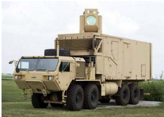
Рис. 3. Мобильная лазерная установка компании Boeing с лазером HEL MD 10 кВт и дизель-генератором 60 кВт на шасси грузовика
