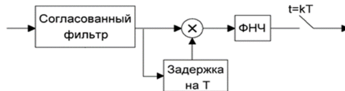
Рис. 1. Схема приемника ОФМ-2
