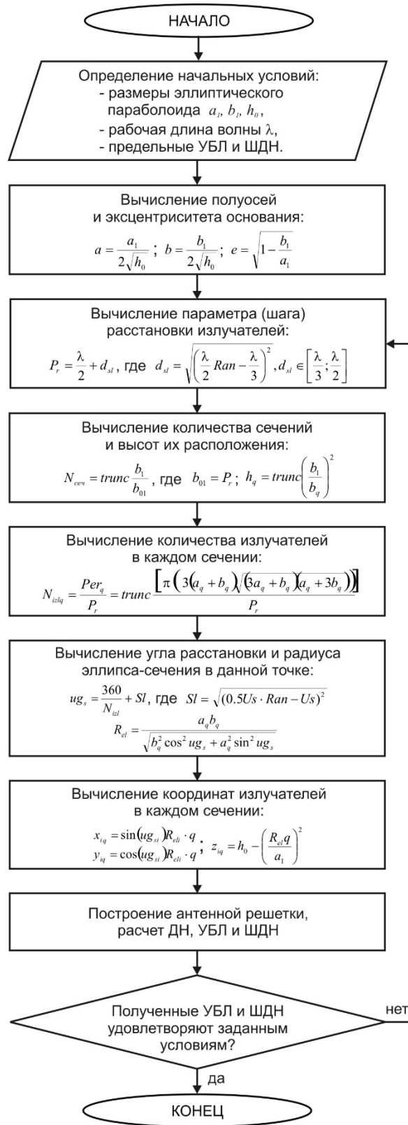
Рис. 2. Блок-схема алгоритма синтеза конформной АФАР
