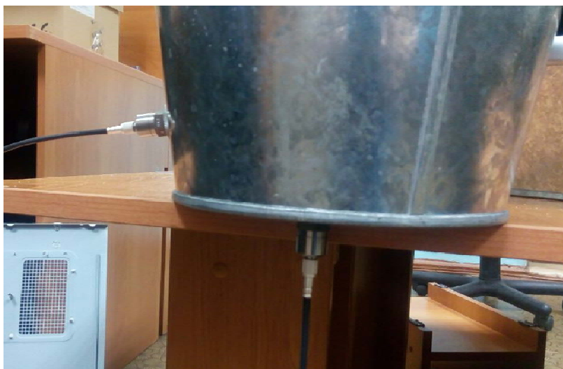
Рис. 3. Металлическая емкость, заполненная песком, с установленными датчиками
