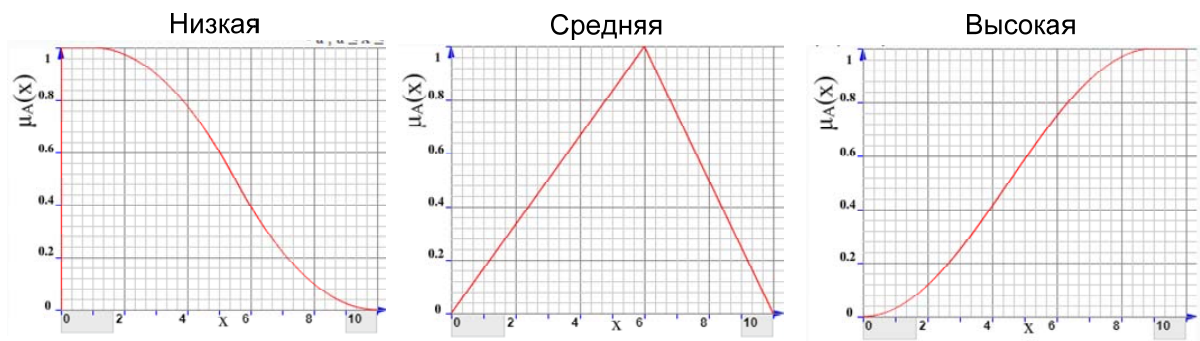
Рис. 4. Функции принадлежности для термов лингвистической переменной пропускная способность
