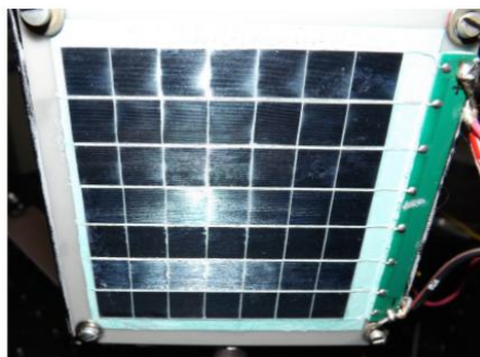
Рис. 1: Матрица фотоэлементов, размер матрицы 7 на 7
