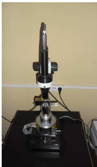
Рисунок 23. Сканирующий зондовый микроскоп Veeco Multi Mode NanoScope IIIa SPM
