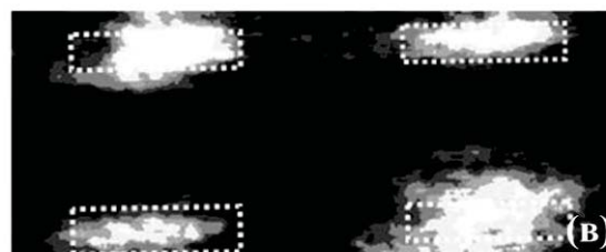
Рис. 3. (а) МРСМ спектр ФМР микрополоски NiFe. РЭМ (б) и МРСМ (в) изображения участка массива микрополосок. Пунктирными линиями показаны положения микрополосок. Размер кадра 11 \times 4 мкм
